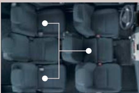
Ein ISOFIX-Verankerungssystem für einen entsprechenden Kindersitz (Zubehör) ist sowohl am vorderen Mittelsitz als auch an den äußeren Rücksitzen angebracht.*
