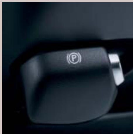
Für einen durchgängig flachen Fahrzeugboden und mehr Beinfreiheit wurde die Handbremse direkt unter das Armaturenbrett verlegt.
