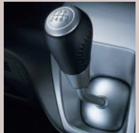
Der Schalthebel wurde in das Armaturenbrett integriert, um Raum zu gewinnen.
