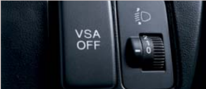
Die Stabilitätskontrolle (VSA) hilft, das Fahrzeug auch in schwierigen Situationen unter Kontrolle zu halten.
