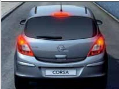
◀ **Adaptives Bremslicht.** Kommt es bei Geschwindigkeiten von mehr als 30 km/h zu Bremsmanövern mit ABS, blinken die Bremslichter fünfmal pro Sekunde – eine wirkungsvolle Warnung für den nachfolgenden Verkehr.
