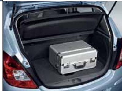
◀ **Ebene Ladefläche.** Ist der doppelte Gepäckraumboden «hochgefahren», bildet er zusammen mit den umgeklappten Rücksitzen eine ebene Fläche zur noch komfortableren Beladung.
