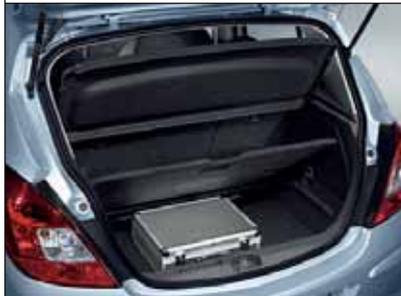
◀ **Doppelter Gepäckraumboden.** Ordnung à la carte: Der in zwei Positionen höhenverstellbare Ladeboden ermöglicht die horizontale Unterteilung des Gepäckabteils.
