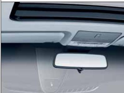
▶ **Sicht-Paket.** Optimale Sicht garantieren der Regensensor und der automatisch abblendende Innenspiegel mit Konsolenbeleuchtung. Je nach Regenmenge und Fahrgeschwindigkeit aktivieren sich die Scheibenwischer vorn selbsttätig.
