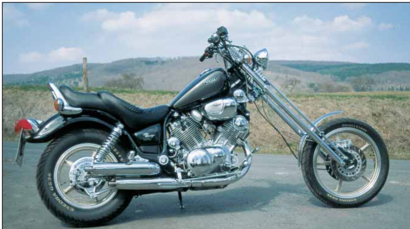
Yamaha XV 1100 Virago ausgestattet mit der AME Neuentwicklung 'Tele - Springer' 14 ° gereckt:
